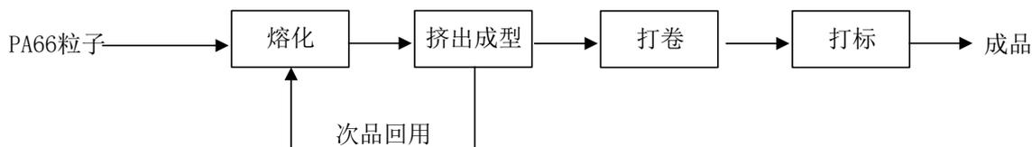
图 4.1-2 断桥隔热穿条工艺流程图
