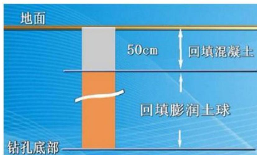
图 7.2 -1 现场封孔示意图
