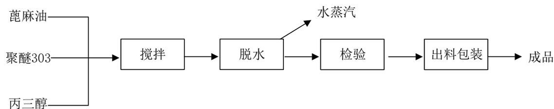
图 4.1-1 (1) 断桥隔热胶及密封胶工艺 A 组分流程图
