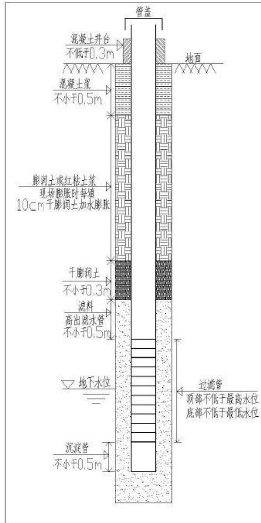
图 7.2-2 地下水监测井结构示意图
