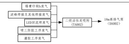
图 3-2 企业工艺废气处理流程图
