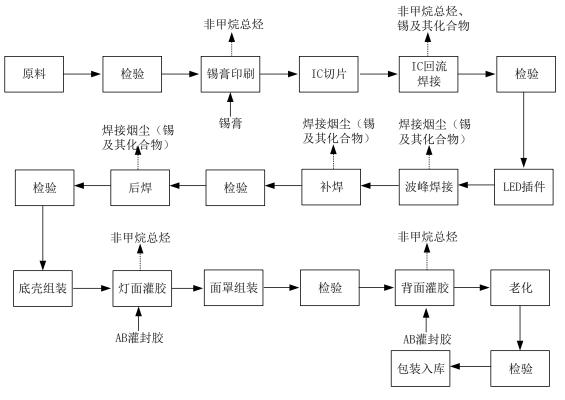
图 2-8 LED 直插模组工艺流程图
