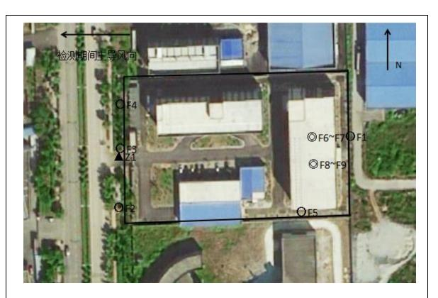
注: ○-无组织废气采样点, ◎-有组织废气采样点, ▲-厂界噪声检测点图 6-1 本项目监测布点图
