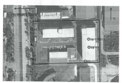
注: ○-无组织废气采样点, ◎-有组织废气采样点, ▲-厂界噪声检测点
