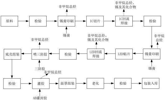
图 2-6 LED 表贴模组工艺流程图
